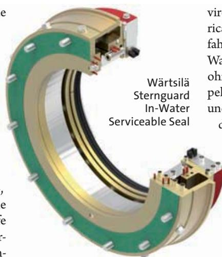
vironmentally Acceptable Lubricants, EAL) oder Mineralölen fahren. Eine Nachrüstung oder Wartung im Trockendock kann ohne die Entfernung des Propellers oder der Welle erfolgen und ein Ablassen des Öls aus dem Stevenrohr ist für die Wartung unter Wasser nicht notwendig. Um die Sicherheit zu erhöhen, beinhaltet die Sternguard IWSS zudem eine aufblasbare Notfalldichtung und einen inneren Seilschutz.
