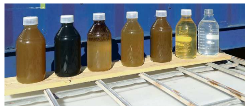
In sieben Schritten reinigt ApatEQ Wasser, bis es klar ist. Fotos: F. Aussems (m. u.), ApatEQ
